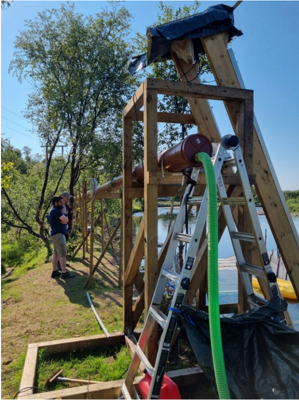
Figur 7.5. Starten på den 85 meter lange rørgaten i Vestre Jakobselv. Pukkellaksen heises opp fra slaktebenken nede til høyre, og tømmes inn i røret. For at pukkellaksen skal gli nedover til de ventende iTub-kassene, ble det i tillegg pumpet vann inn i røret. (Foto: Egil Liberg)
