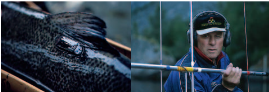
Fisk med radiosender kan posisjoneres ved manuell peiling fra bil, båt eller til fots med bærbar radiomottaker. Individuer kjennes igjen ved ulike koder eller frekvenser på signalene. Merket fisk som passerer et bestemt sted, eller oppholder seg for eksempel utenfor et kraftverksutløp, kan registreres ved å sette opp en fast lyttestasjon. Foto: E. B. Thorstad
