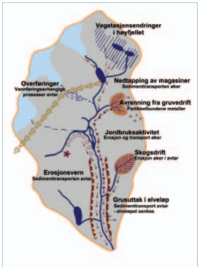
Fig. 3. Materialstrømningsmodell som illustrerer hvordan forskjellige aktiviteter i vassdraget påvirker sedimenttilførselen til hovedløpet i et vassdrag.
