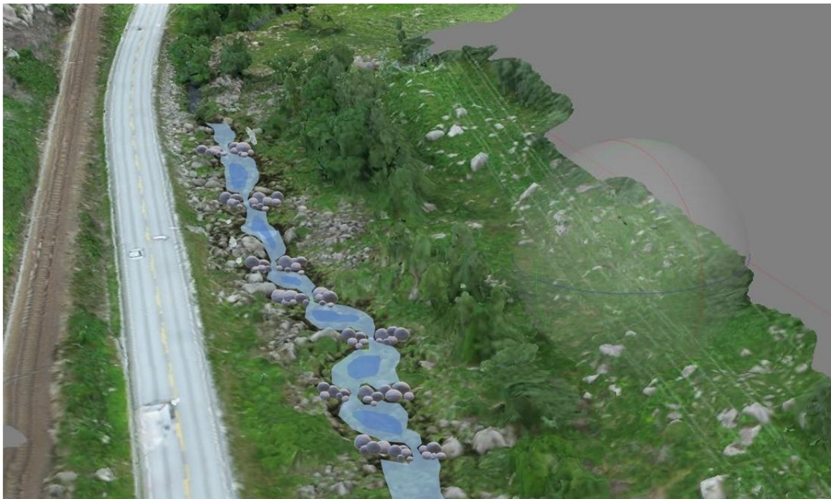
Figur 31. Prinsippskisse av «pool-step» konsept gjennom et av de tøffere områdene av Litlåna. Se Hauer og Flödl (2022) i appendiks A for nærmere beskrivelse og mål.
