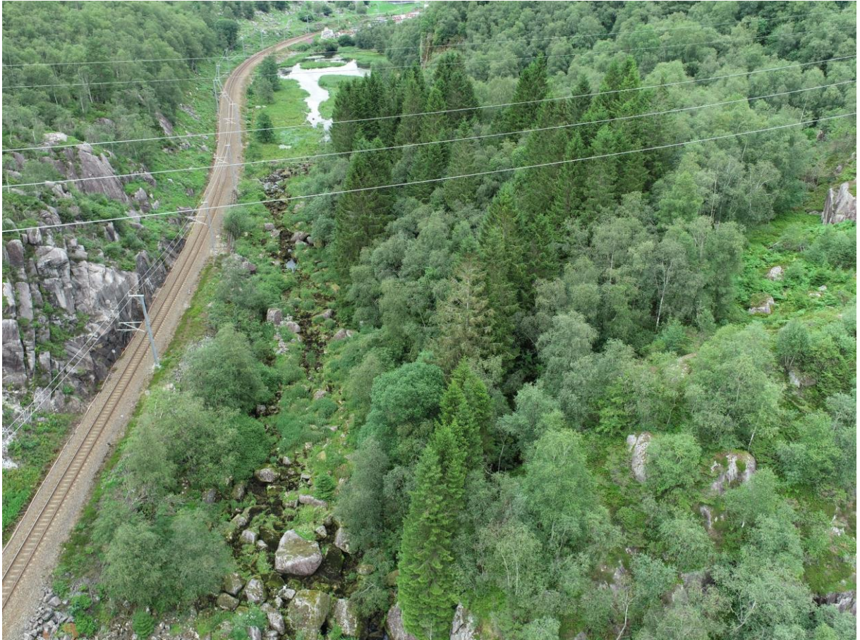
Figur 20. Bildet viser et område av Litlåna hvor elven er bred, substratet er grovt og gradienten er relativt høy (omkring 13,5 % på det bratteste). Dette punktet vil kreve en del vann, og eventuelt terrengtilpasning for å bli passerbart for fisk.
